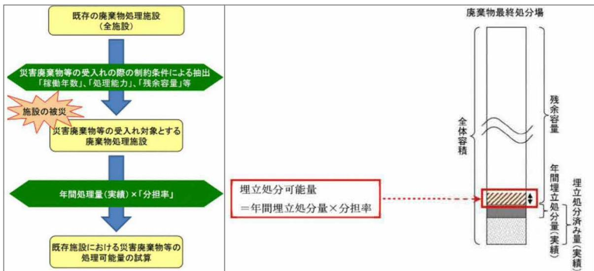
図2-7-2 最終処分場の処理可能施設抽出の考え方
